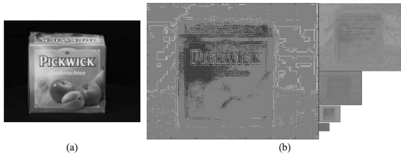
Fig. 1. (a) Imagen de referencia I . (b) Pirámide de escalas utilizando la transformada wavelet de Haar de I .
